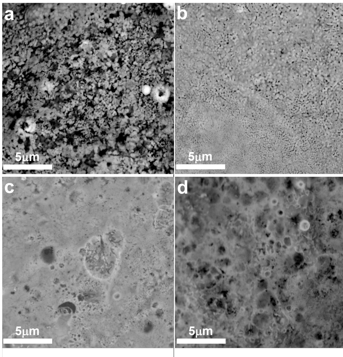
Figure S1. SEM images of pristine microelectrodes (a) ME-1, (b) ME-2, (c) ME-3 and (d) ME-4.
