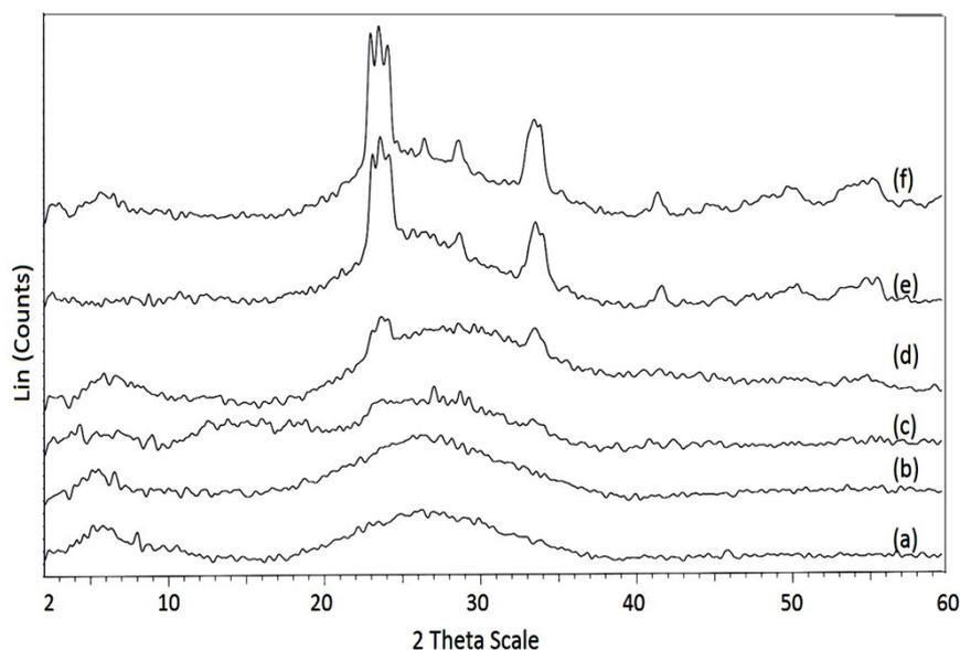
**Figure S.1:** X-ray diffraction profiles of various  $\text{WO}_x/\text{TiP}$  catalysts. (a) Pure TiP (b) 5 wt%  $\text{WO}_x/\text{TiP}$  (c) 10 wt%  $\text{WO}_x/\text{TiP}$  (d) 15 wt%  $\text{WO}_x/\text{TiP}$  (e) 20 wt%  $\text{WO}_x/\text{TiP}$  (f) 25 wt%  $\text{WO}_x/\text{TiP}$ .
