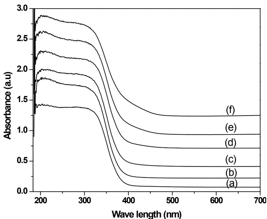
**Figure S.2:** UV-Vis spectra of various  $\text{WO}_x/\text{TiP}$  catalysts. (a) Pure TiP (b) 5 wt%  $\text{WO}_x/\text{TiP}$  (c) 10 wt%  $\text{WO}_x/\text{TiP}$  (d) 15 wt%  $\text{WO}_x/\text{TiP}$  (e) 20 wt%  $\text{WO}_x/\text{TiP}$  (f) 25 wt%  $\text{WO}_x/\text{TiP}$
