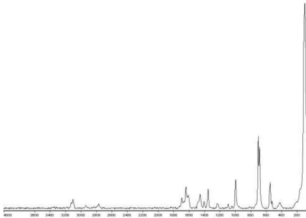
Raman spectrum of the salt  $\text{CaBA}_2 \cdot 3\text{H}_2\text{O}$ .
