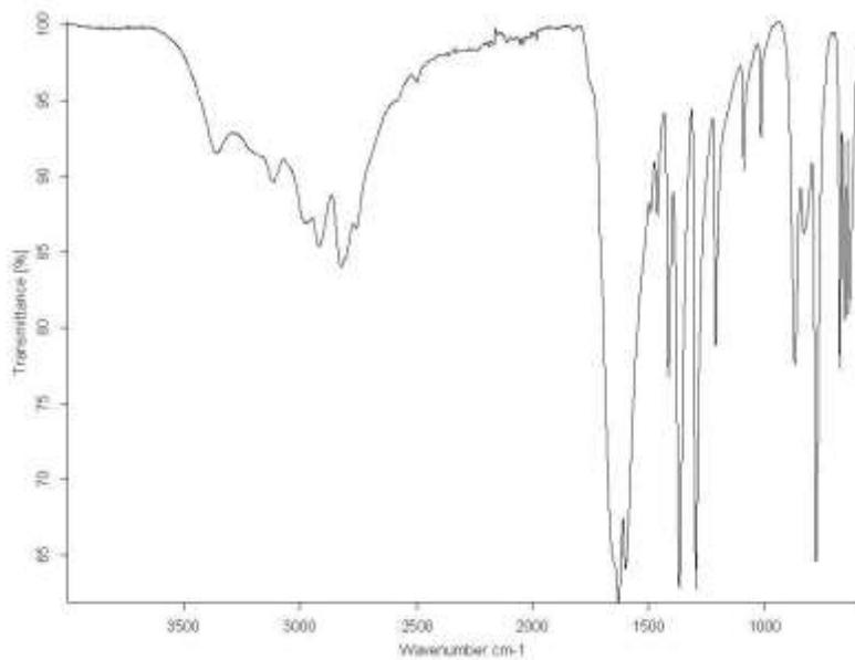
IR (ATR) spectrum of  $\text{NaBA} \cdot \text{H}_2\text{O}$ .
