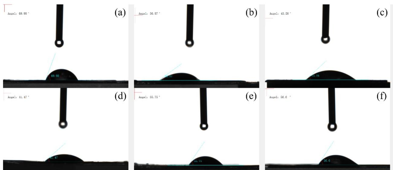
Figure S3. Water contact angles of (a) S-NZVI<sub>one</sub>-Na<sub>2</sub>S, (b) S-NZVI<sub>one</sub>-Na<sub>2</sub>S<sub>2</sub>O<sub>4</sub>, (c) S-NZVI<sub>one</sub>-Na<sub>2</sub>S<sub>2</sub>O<sub>3</sub>, (d) S-NZVI<sub>two</sub>-Na<sub>2</sub>S, (e) S-NZVI<sub>two</sub>-Na<sub>2</sub>S<sub>2</sub>O<sub>4</sub>, (f) S-NZVI<sub>two</sub>-Na<sub>2</sub>S<sub>2</sub>O<sub>3</sub>.
