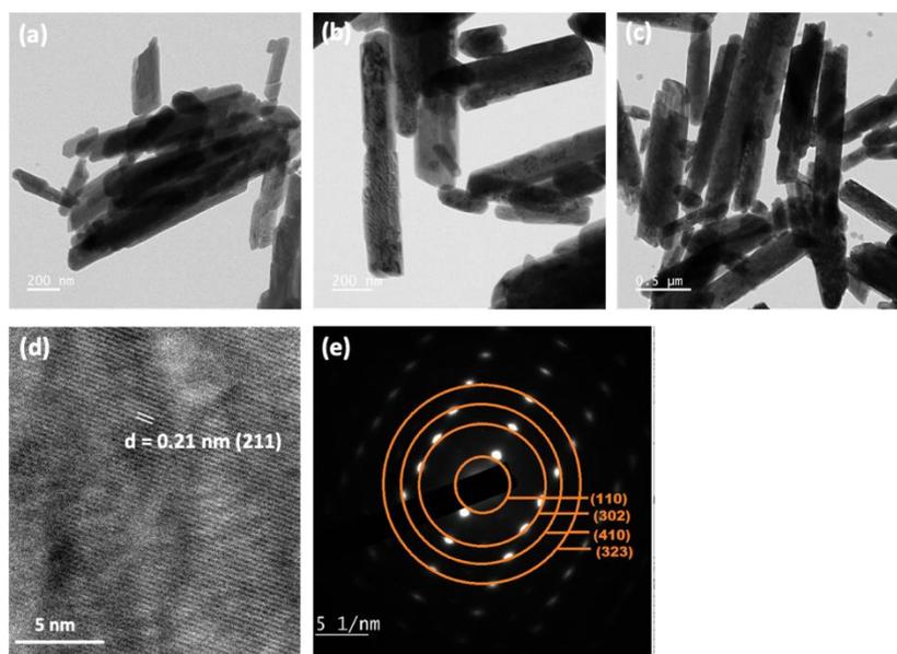
Fig. SI2 (a-c) TEM images of  $\text{YPO}_4:10\% \text{Tb}^{3+}$  (d) HRTEM image of  $\text{YPO}_4:10\% \text{Tb}^{3+}$  (e) SAED pattern of  $\text{YPO}_4:10\% \text{Tb}^{3+}$
