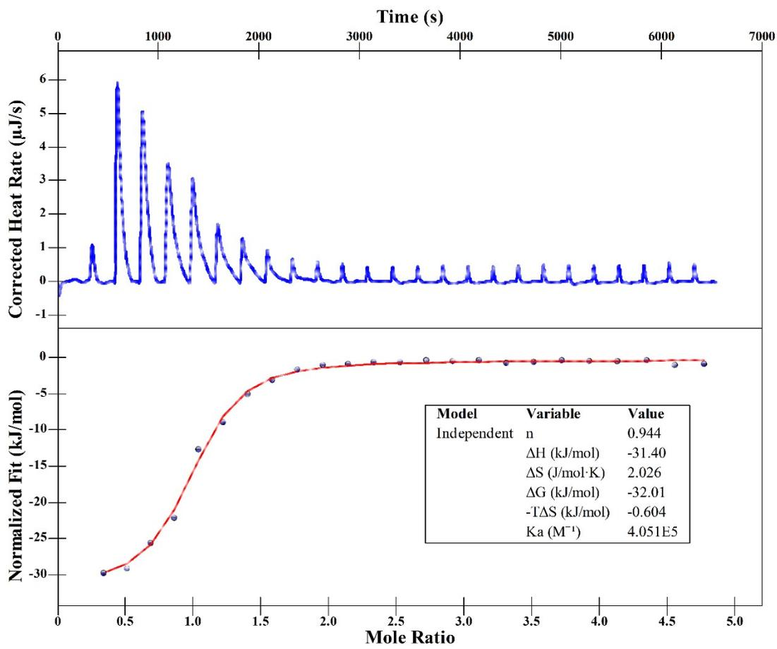
**Figure S11.** Titration diagram for isothermal titration calorimetry of G2@TMeQ[6].
